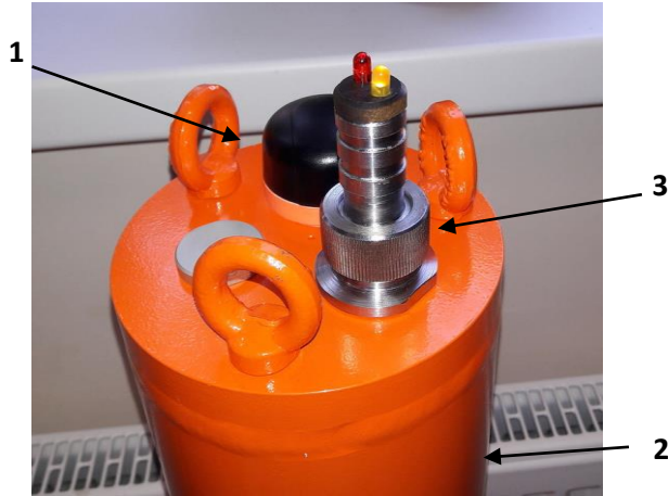
Рис. 2.1.4. Верхняя крышка корпуса гео-гидроакустического модуля: 1 – внешняя антенна Wi-fi/GPS, 2 – герметичный разъём типа PC-10, 3 – светоиндикаторная заглушка
