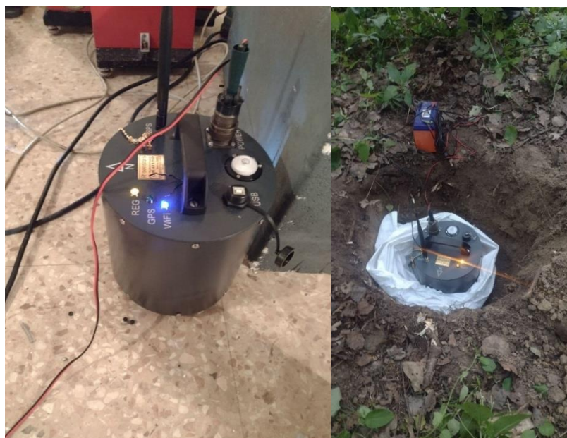
Рис. 5.4. Трёхкомпонентные сейсмометры СМЕ-6111ND: слева – установленный на постаменте ГФО «Михнево», справа – установленный в одной из периферических точек
