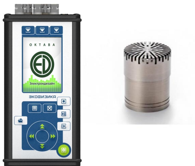
Рис. 4.3.2.1. Шумомер Октава «ЭКОФИЗИКА-110А» (слева) и акустический микрофонный капсюль «ВМК-205» (справа)
