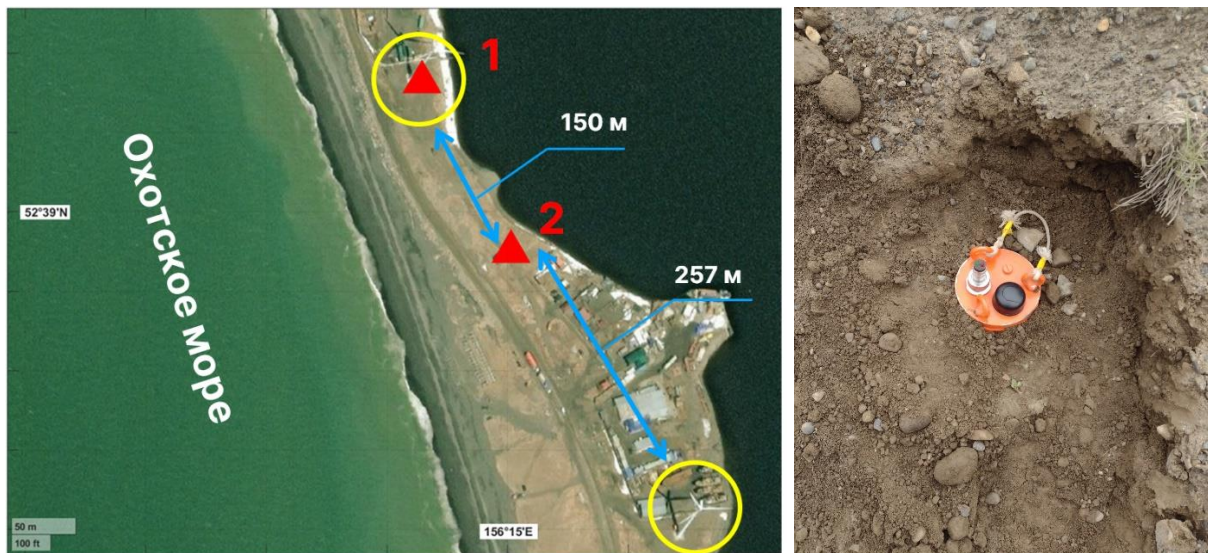
Рис. 2.5.2. Схема расположения измерительных пунктов на территории пос. Октябрьский (слева) и установка сейсмостанции в измерительной точке (справа)
