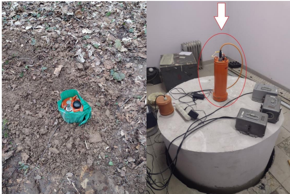
Рис. 4.1.4. Переносная сейсмостанция, установленная в одной из измерительных точек (слева) и сейсмостанция, расположенная на опорном пункте в КПЦ ИФЗ РАН (справа)
